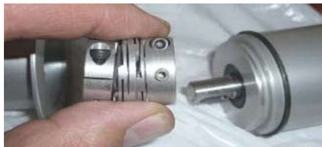
Quel che resta dell'accoppiatore della pompa idraulica dell'Antares, deputata ad estrarre il motore e retrarre il carrello
